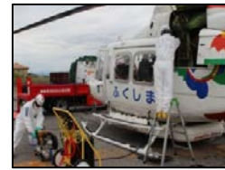
ヘリコプター除染用資機材 によるエンジン除染
